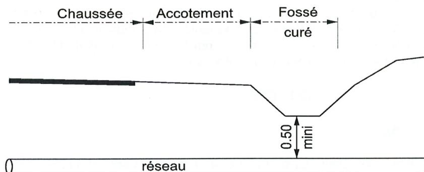
Le remblaiement du fossé se fera à l'aide de matériaux étanche et de façon à ce que le fil d'eau ne présente aucune contre pente ou point bas.
